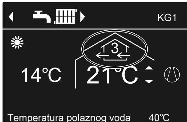
Slika 20 Primjer za ventilaciju u pogonskom programu »**Automatska ventilacija**«, status pogona »**Normalno**«
